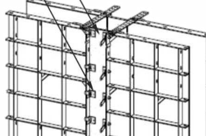
Rys. 30. Przykłady zastosowania kątowników do sklejki 21 mm
