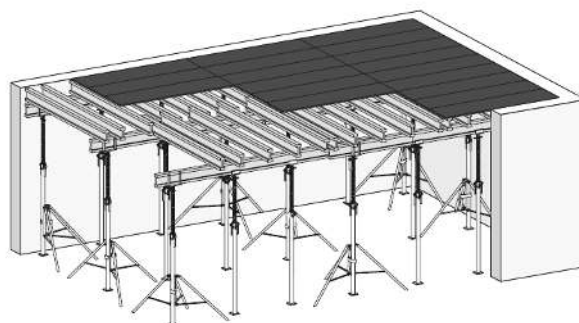
Rys. 15. Schemat ułożenia blatów poszycia
