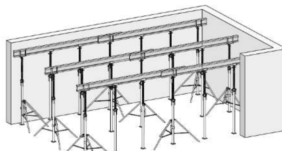
Rys. 13. Rozmieszczanie podpór pośrednich
