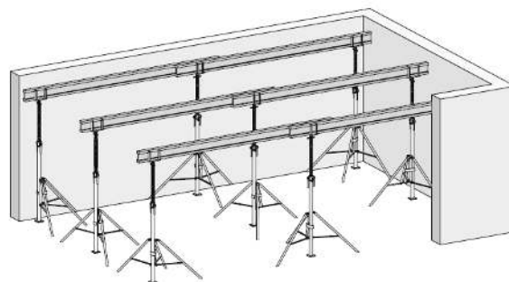
Rys. 12. Układanie dźwigarów podłużnych
